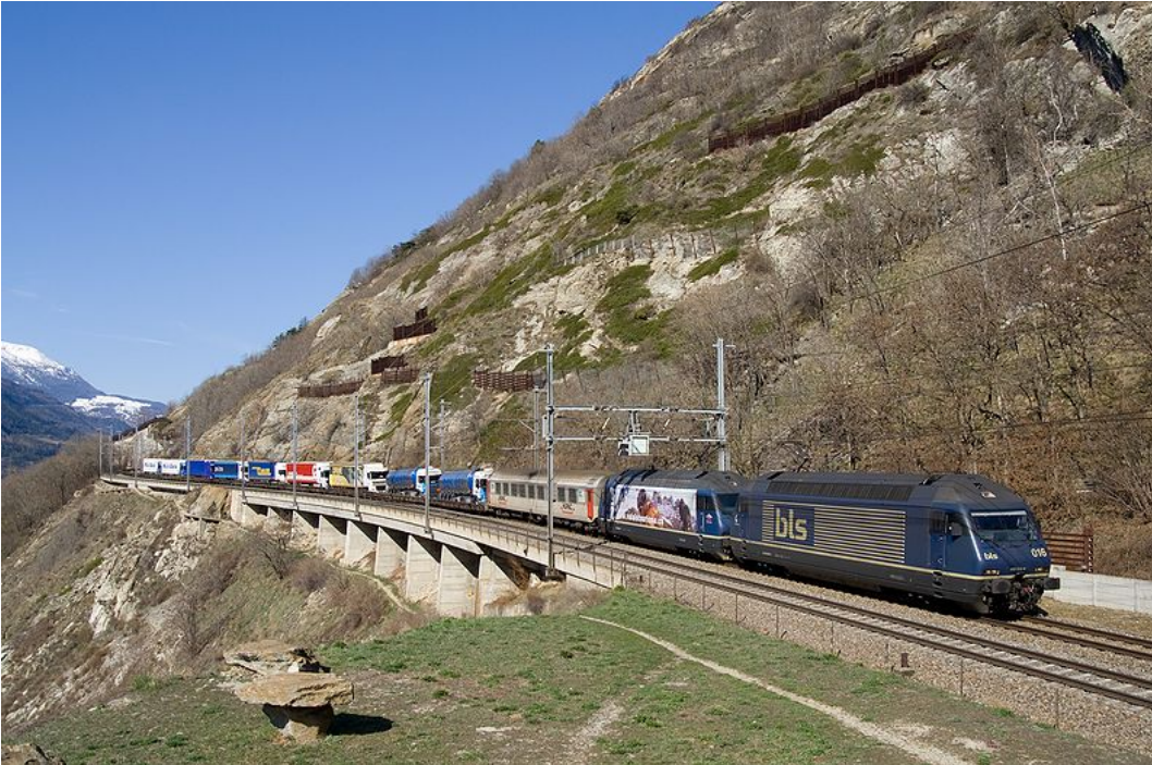
Figura 5. Autoestrada rolante na linha Lötschberg, na Suíça, rebocada por um par de locomotivas Re 465. Note-se a carruagem de passageiros para os motoristas.
